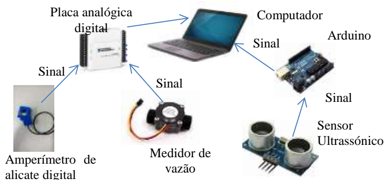
Figura 10: Diagrama do sistema de supervisão e aquisição de dados Fonte: Do autor
