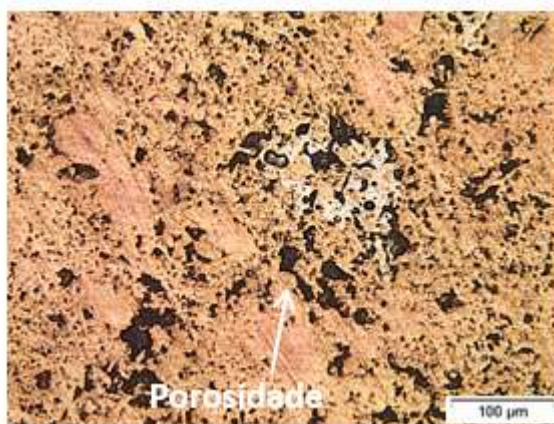
Figura 9: Microestrutura do Bronze SAE 841 em estado fornecido 200x, sem ataque. Fonte: Do autor
