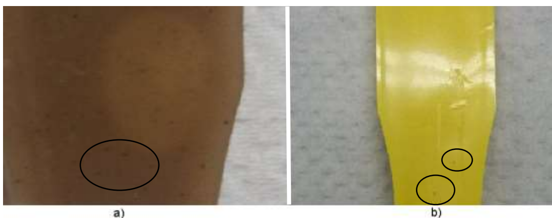
Figura 9: Pontos negros nos corpos de prova: a) CP2 e b) CP4 Fonte: Do autor
