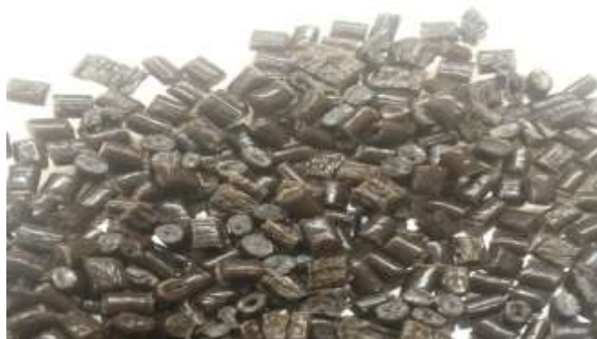
Figura 5: Masterbatch obtido pela incorporação do pigmento sintetizado em PEBDL Fonte: Do autor
