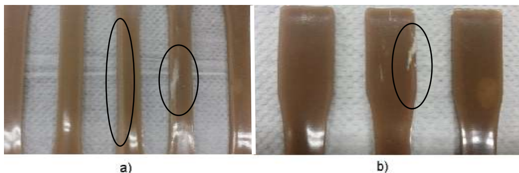
Figura 8: Manchas superficiais nos corpos de prova: a) CP1 e b) CP2 Fonte: Do autor
