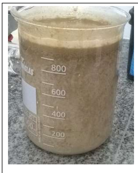
Figura 6: Floculante Sulfato de Alumínio e cal calcítica Fonte: Do autor
