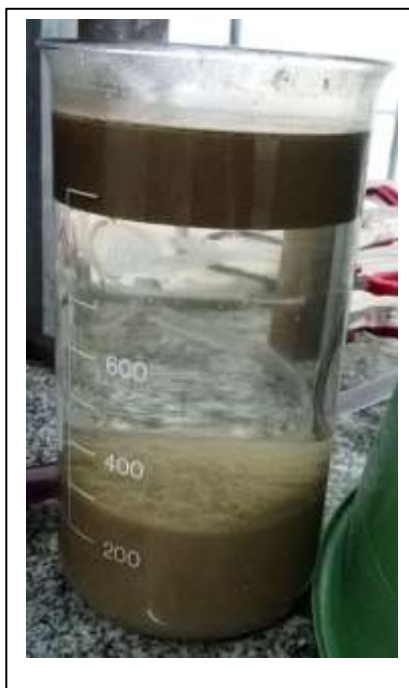
Figura 5: Floculante Sulfato de Alumínio e NaOH Fonte: Do autor
