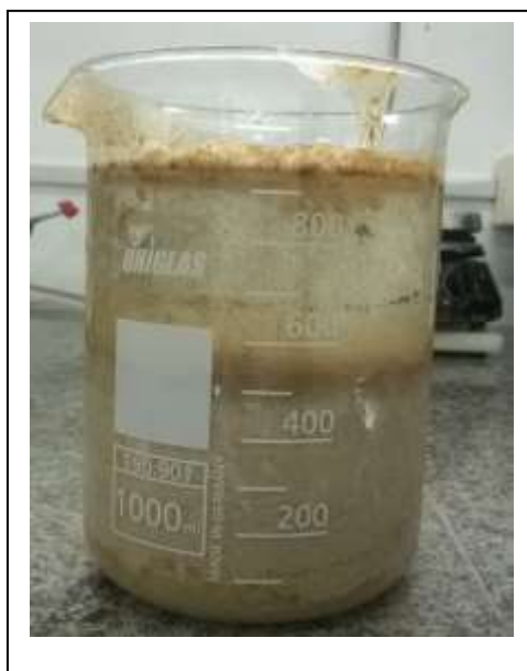
Figura 7: Floculante Sulfato de Alumínio e cal dolomítica Fonte: Do autor
