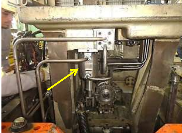
Figura 1: Instalação Servo Atuador Hidráulico
