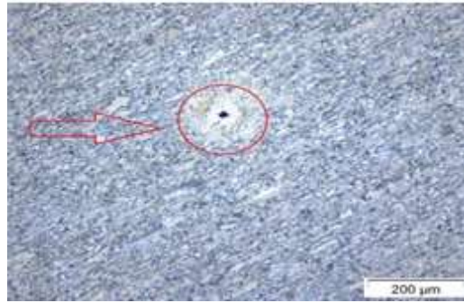
Figura 17: Ensaio de metalografia revelando precipitação no ponto em destaque.
