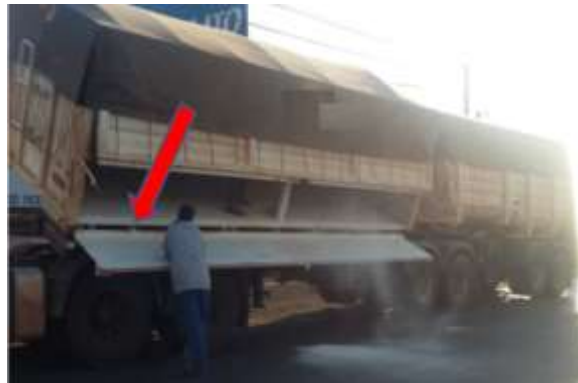
Figura 9: Identificando local de trincas recorrente (b).
