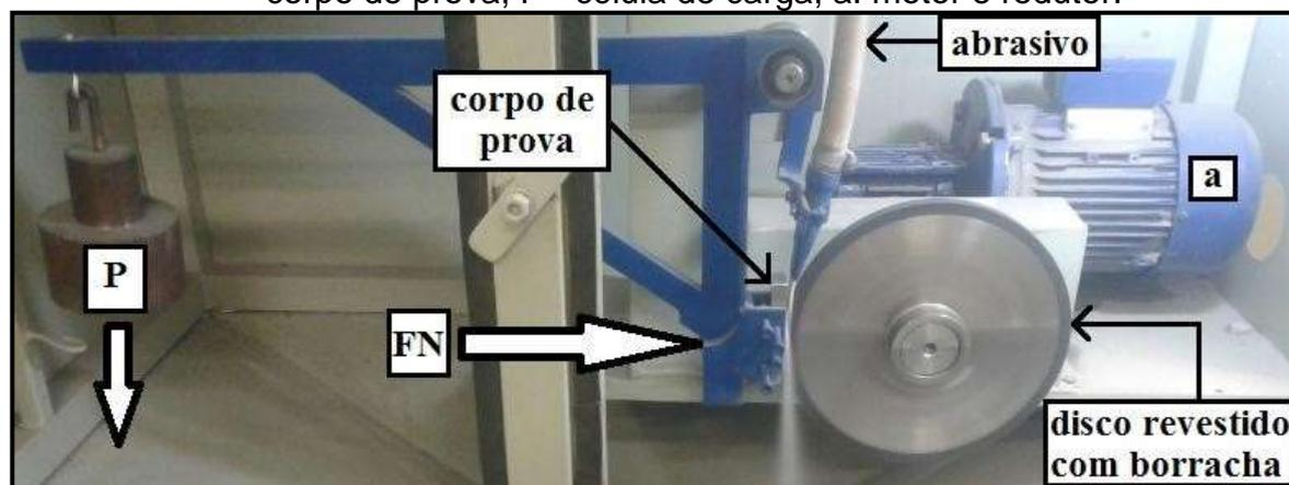
De acordo com a norma vigente do processo de desgaste o revestimento no material de base utilizado nos corpos de prova se caracteriza no procedimento A onde, a vazão da areia que servirá como material abrasivo entre o disco e o corpo de prova foi de 400 g/min, com uma célula de carga de 5 Kg tendo uma força atuante no corpo de prova em contato com o disco de 130 N. O disco é revestido de borracha com uma dureza de 60 shore e trabalha com uma rotação de 200 rpm.
