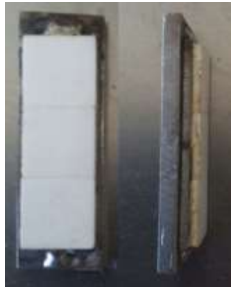
Figura 5: Corpo de prova revestido com alta alumina.
