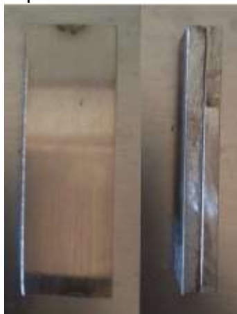
Figura 4: Corpo de prova revestido com aço inox AISI 304.
