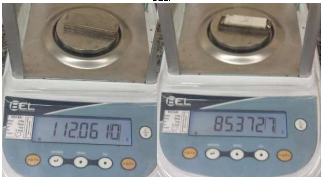
Figura 6: Amostras de aço inox AISI 304 e Alta alumina respectivamente na balança BEL.
