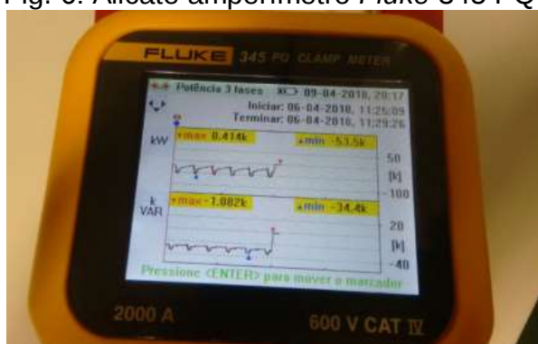
Fig. 6: Alicate amperímetro Fluke 345 PQ
