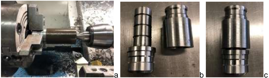
Figura 09: Usinagem no torno CNC (a), bucha e coluna (b) e conjunto guia (c).
