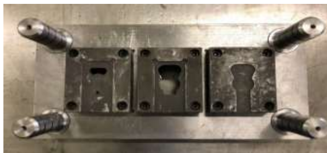
Figura 15: Montagem das matrizes de corte na base inferior.
