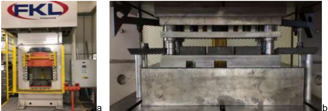
Figura 18: Prensa hidráulica FKL (a) equipada com a matriz de estampagem (b).
