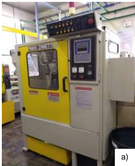
Figura 8: Equipamentos a serem utilizados, onde: a) Máquina de sopro PAVAN ZANETTI; b) Limites de projeto do molde.
