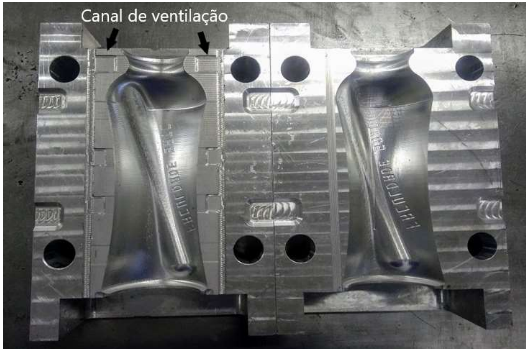
Figura 20: blocos de alumínio após usinagem final para o corpo da garrafa.
