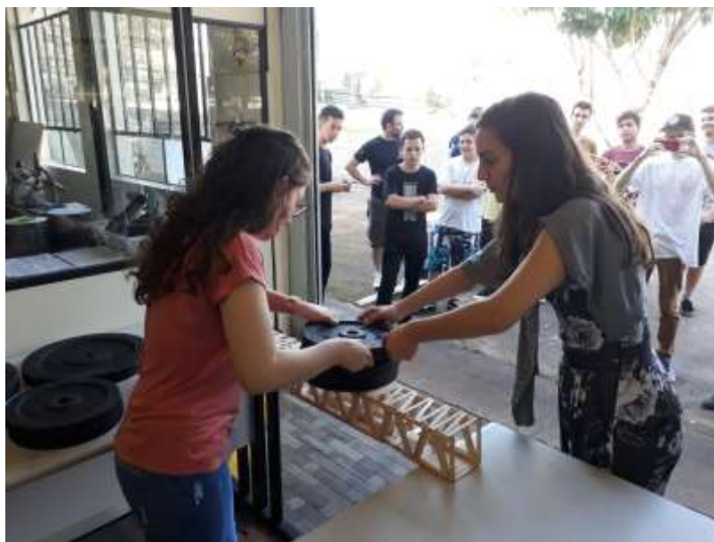
Figura 5: Colocação dos pesos 2 na ponte de palito de picolé.
