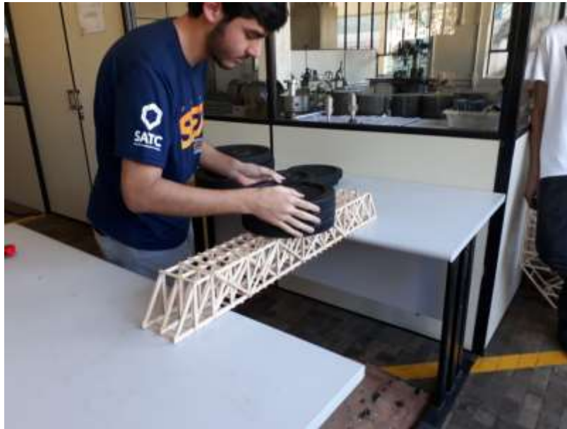
Figura 4: Colocação dos pesos 1 na ponte de palito de picolé.
