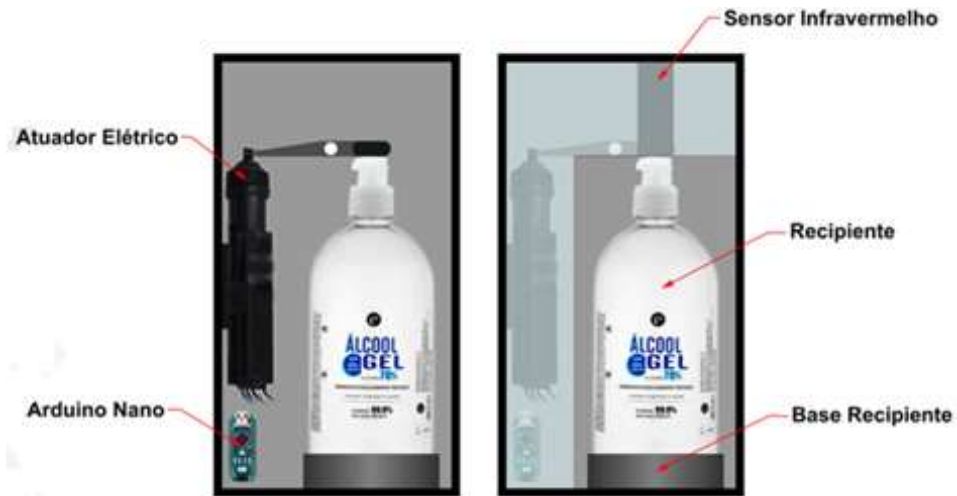
Figura 12: Higienizador com acionamento automático.
