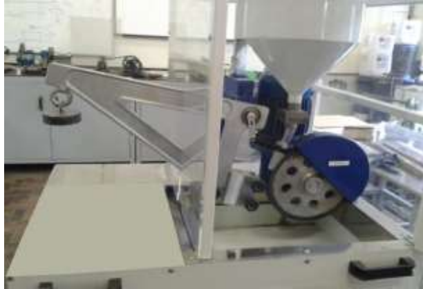
Figura 1: Abrasômetro Roda de Borracha e Areia Seca Padronizado ASTM G-65
