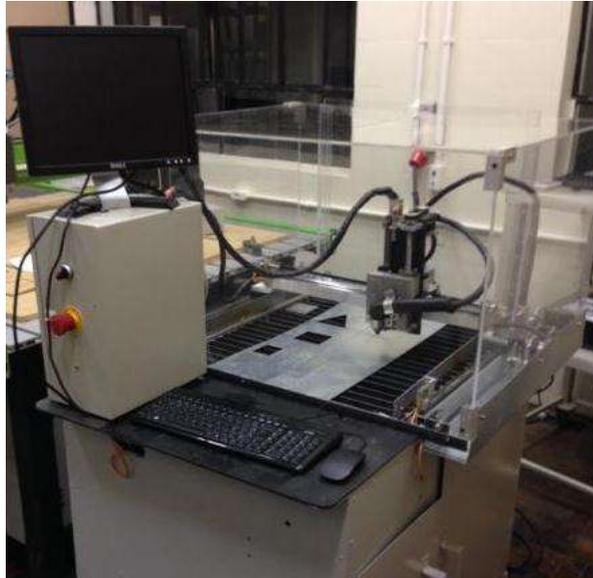
Figura 16: Protótipo didático corte plasma CNC.
