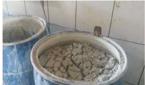
Figura 4: Leito de secagem com lodo residual.
