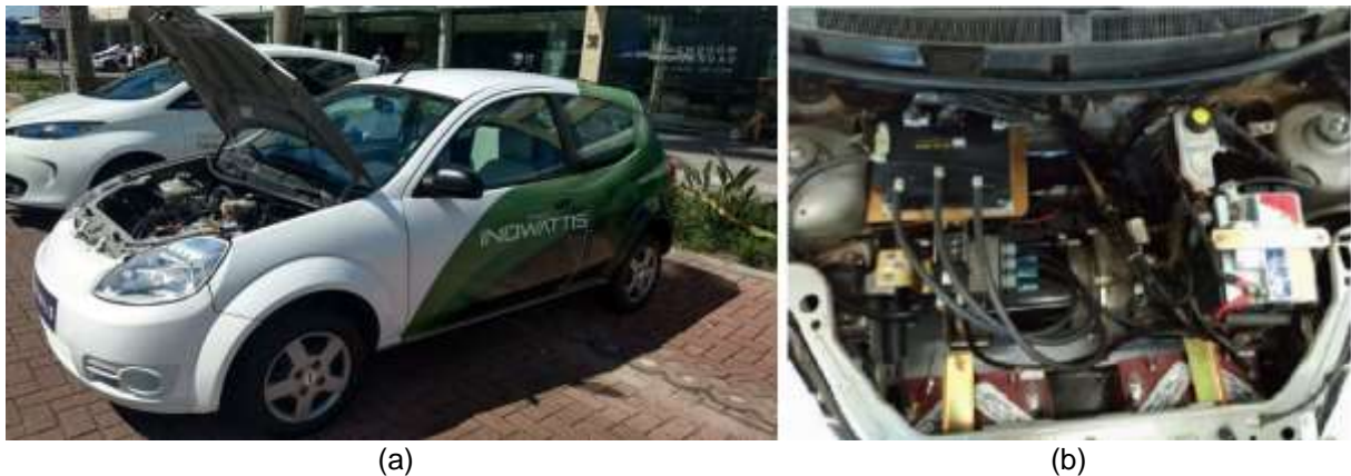
Figura 1a – INOWATTIS. Figura 1b – Motor elétrico acoplado no Veículo Fonte: Adaptado de Fornasa (2018)
