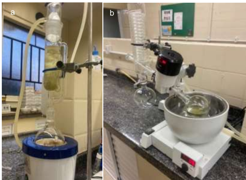
Figura 2: Extração por Soxhlet (a) e recuperação do solvente (b).
