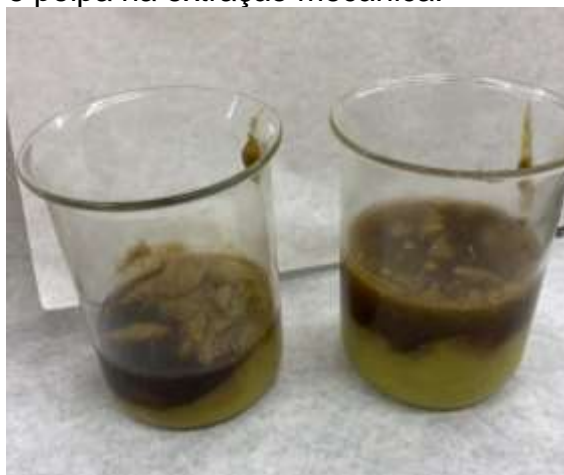
Figura 3: Separação de fases entre óleo e polpa na extração mecânica.
