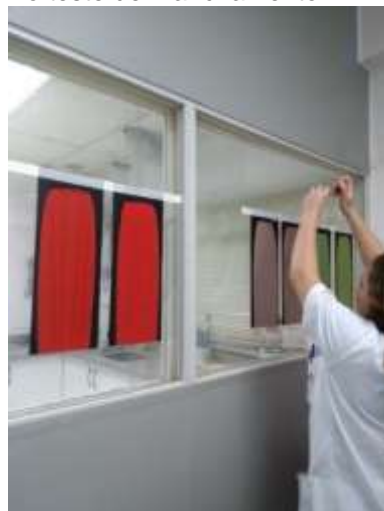
Figura 8: Escoamento da água no teste de manchamento.
