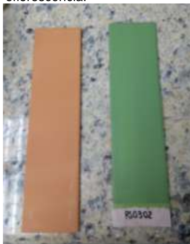
Figura 9: Aplicação do teste de eflorescência.
