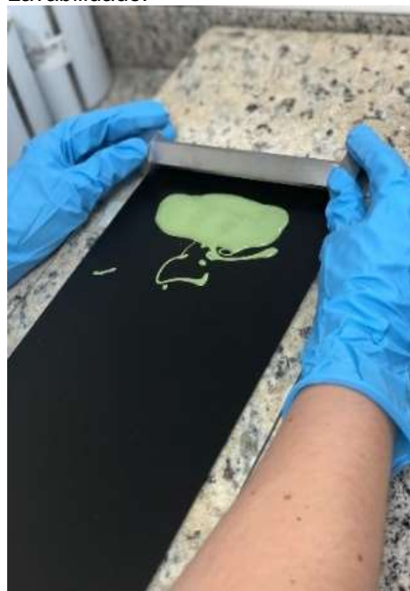
Figura 6: Aplicação do teste de Lavabilidade.
