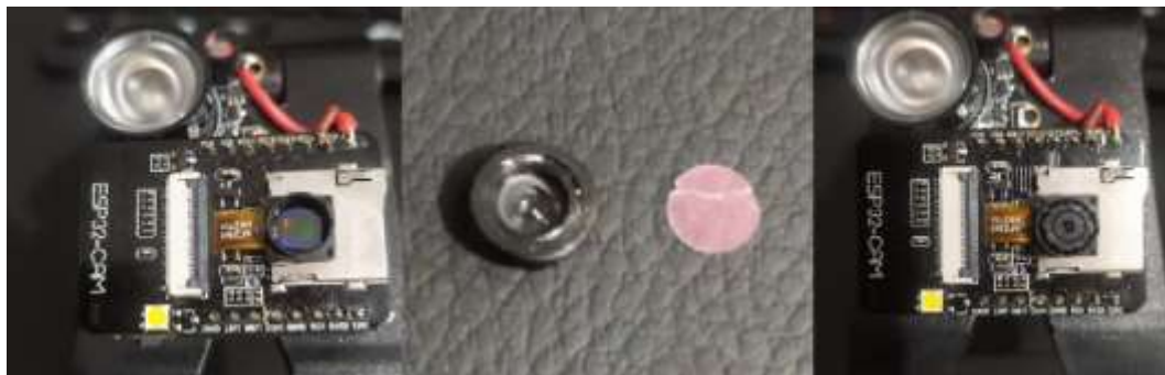
Figura 8: Alteração do hardware para remover o filtro infravermelho
