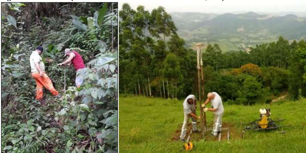
Figura 6 – Perfurações a trado manual e mecanizado, respectivamente
