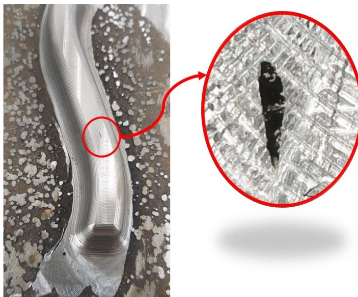
Figura 11: Defeito na Fusão dos Cordões
