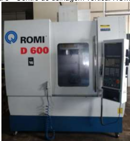
Figura 3 - Centro de usinagem vertical ROMI D600
