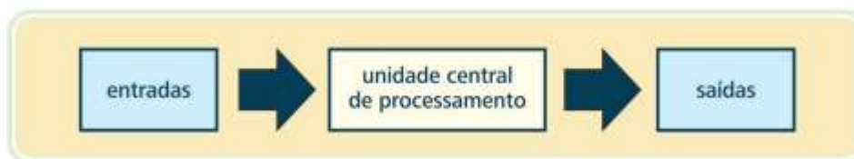
Figura 3: Sistema de funcionamento do CLP.
