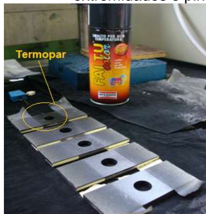
Figura 7 – Preparação das amostras ensaiadas: fixação do termopar, isolamento das extremidades e pintura (a) e amostras prontas (b).
