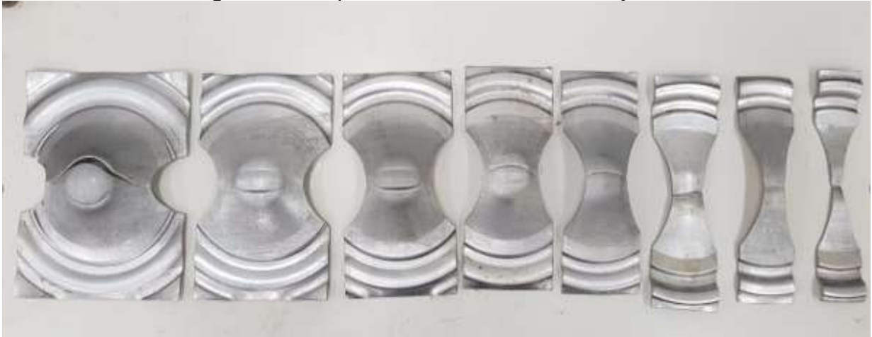
Figura 14: Corpos ensaiados, ensaio Nakajima.
