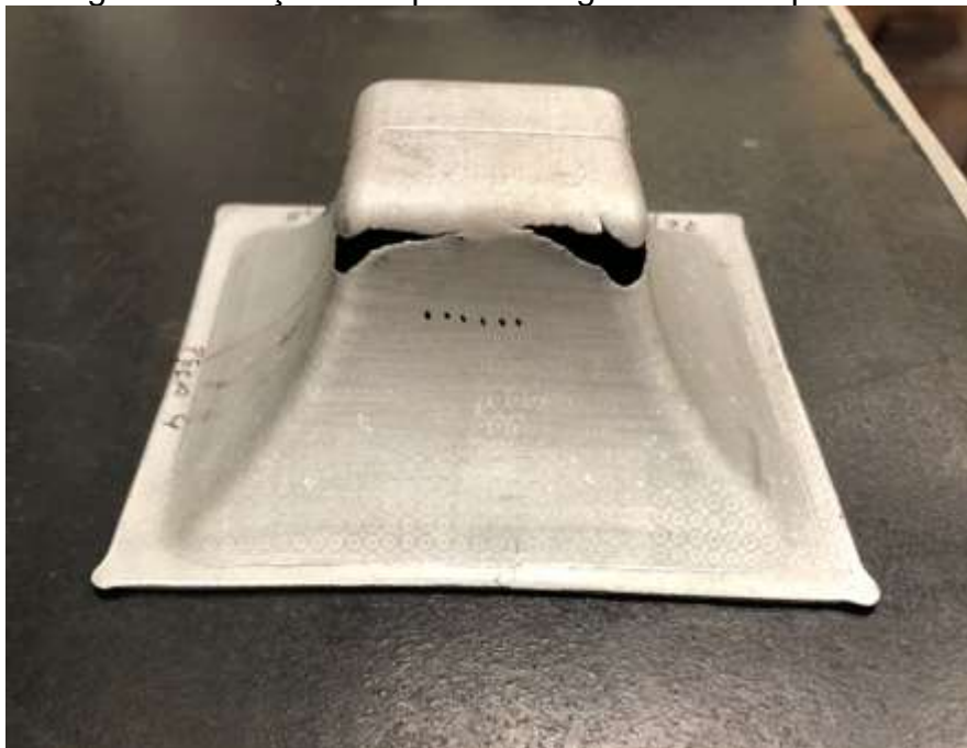
Figura 17: Peça estampada com geometria de pirâmide
