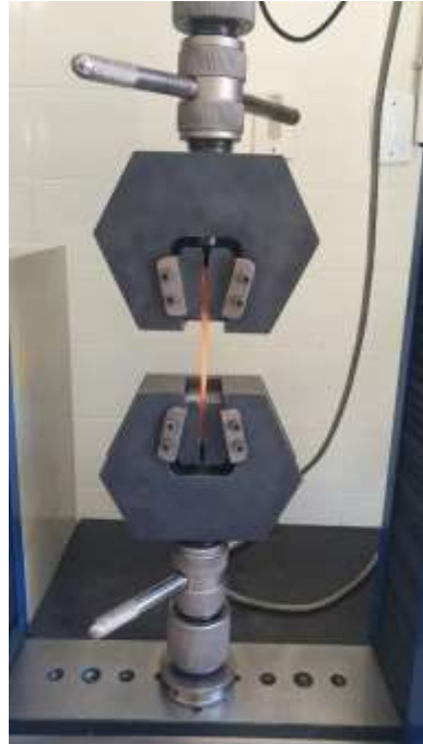
Figura 11: Corpo de prova sendo ensaiado
