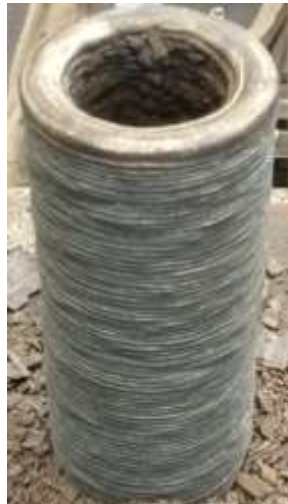
Figura 11: Primeiro protótipo, fabricado em aço de baixa liga (arame eletrodo E71-T1).
