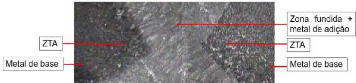
Figura 16: Macrografia do cordão de solda sem pré-aquecimento.
