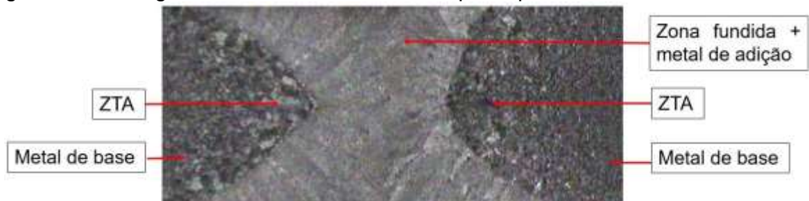
Figura 17: Macrografia do cordão de solda com pré-aquecimento.
