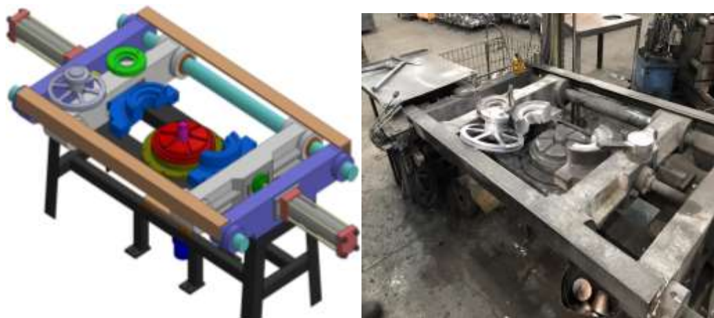
Figura 11- Projeto da coquilhadeira x coquilhadeira real
