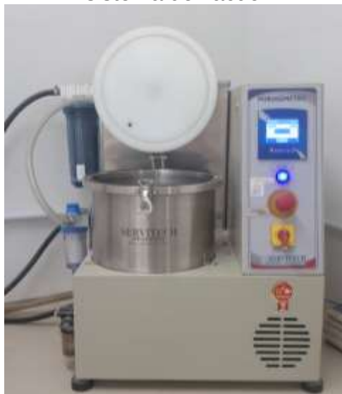
Figura 5: Porosímetro: aparelho de ensaio de absorção d'água – câmara de vácuo e sistema de vácuo.
