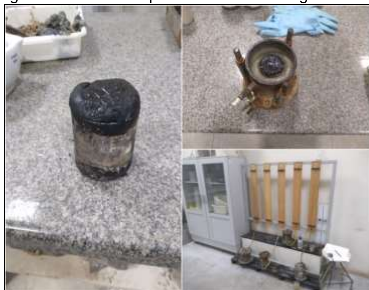
Figura 5 – Ensaio de permeabilidade a carga variável.
