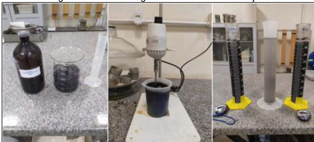
Figura 7 – Ensaio de granulometria - sedimentação.
