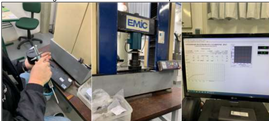
Figura 6 – Ensaio resistência a compressão uniaxial.
