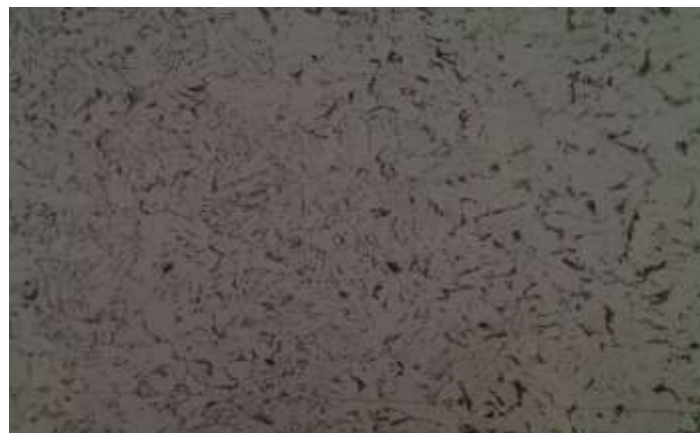
Figura 11 - ZTA (Zona Térmica Afetada) solda robotizada do aço 1020.
