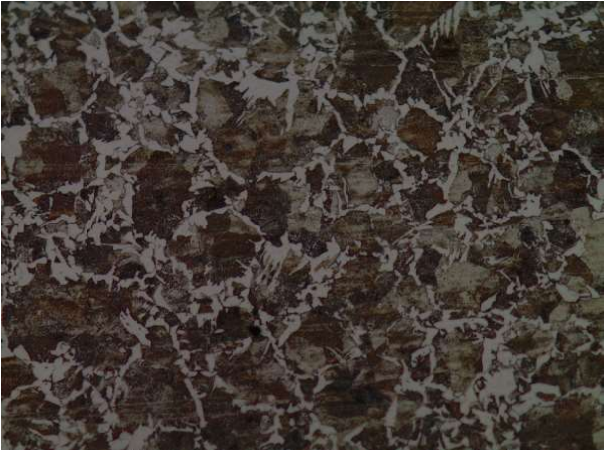
Figura 7 - ZTA (Zona Térmica Afetada) solda manual do aço 1045.
