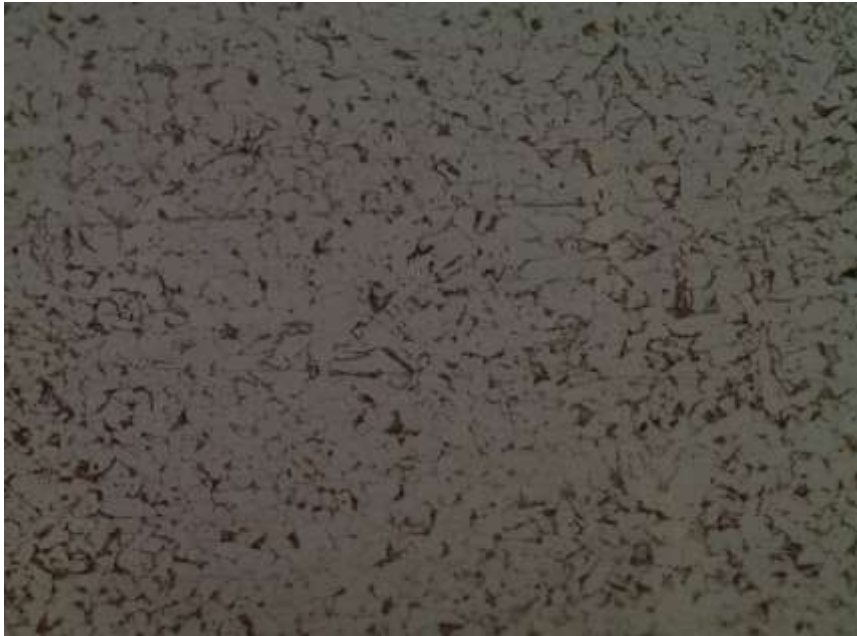
Figura 8 - ZTA ( Zona Térmica Afetada ) solda manual do aço 1020.
