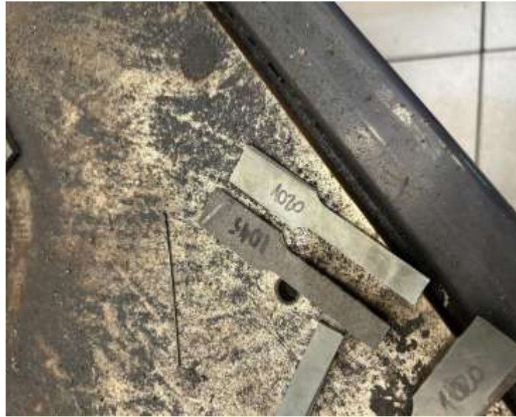
Figura 1 - Peça feita de aço 1045 e peça de aço 1020 que serão unidas.
