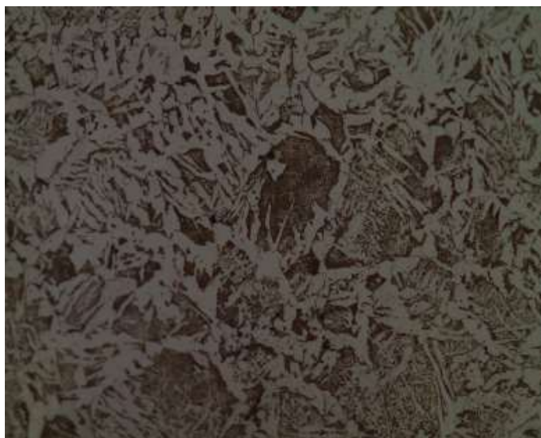
Figura 9 - ZTA (Zona Térmica Afetada) solda robotizada.
