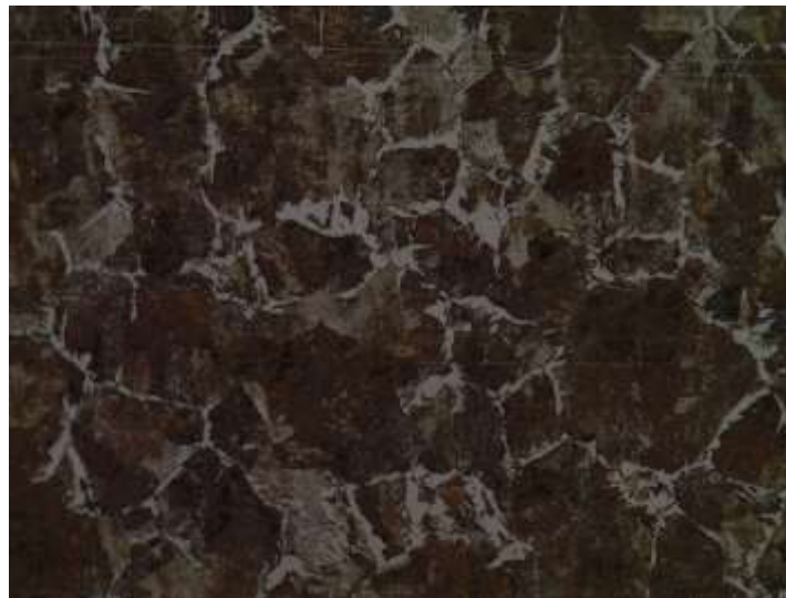
Figura 10 - ZTA ( Zona Térmica Afetada ) solda robotizada do aço 1045.
