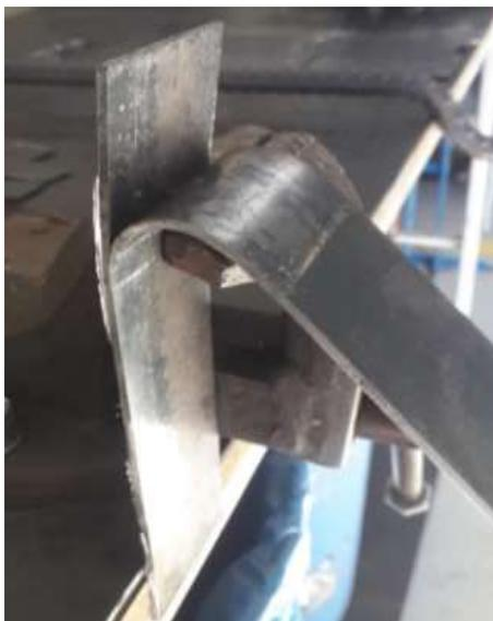
Figura 7 -Dobramento de juntas de 2 x 2 mm
