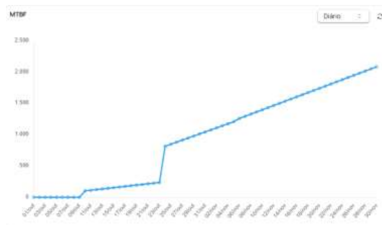
Fig. 13: Análise do MTBF (Tempo Médio Entre Falhas) em um período de dois meses incompletos.
