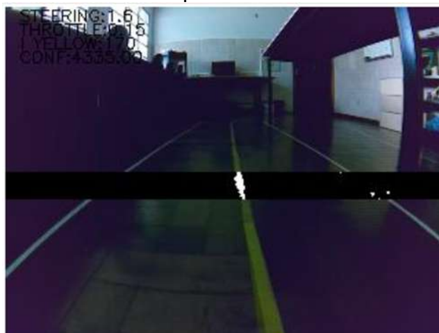
Fig. 5. Teste de visão computacional com as luzes apagadas.
