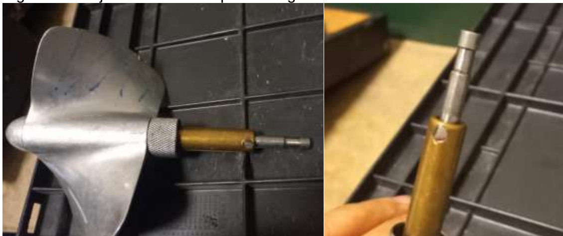
Figura 5: Conjunto da hélice e ponto magnético de um molinete comercial.
