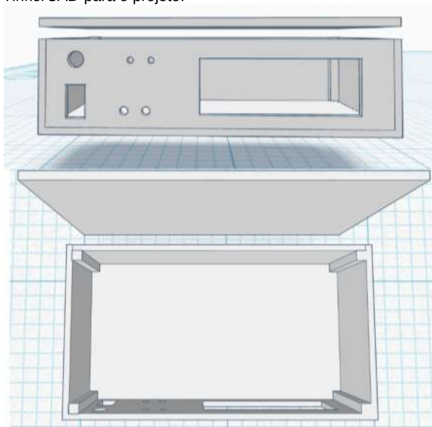
Figura 10: Vistas frontal e superior da carcaça 3D desenvolvida no TinkerCAD para o projeto.
