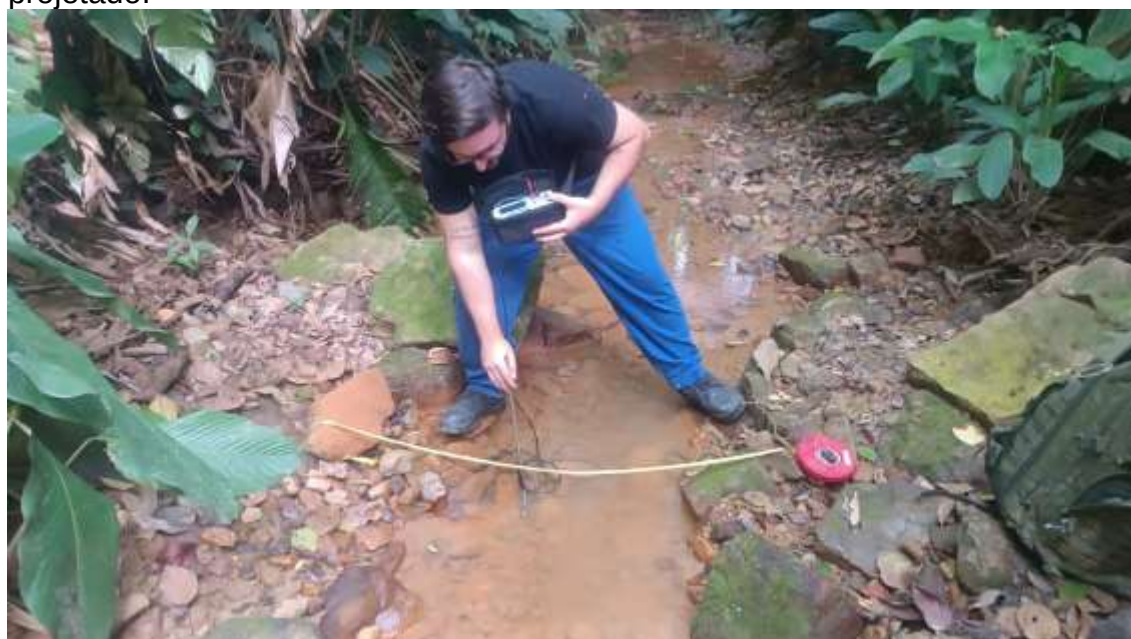
Figura 14: Realização da medição de vazão no ambiente de teste, com contador projetado.
