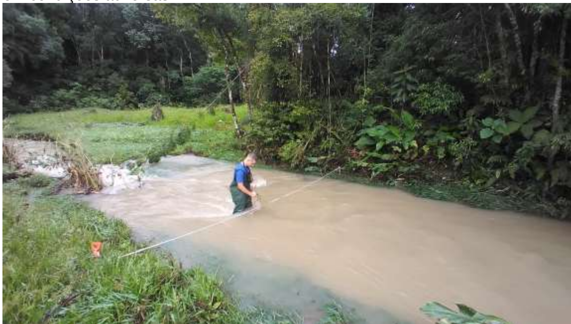
Figura 2: Medição de vazão in situ com molinete hidrométrico e contador de pulsos em condições adversas.
