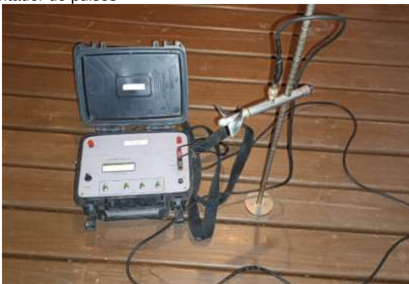
Figura 7: Conjunto montado, micro molinete com haste e contador de pulsos
