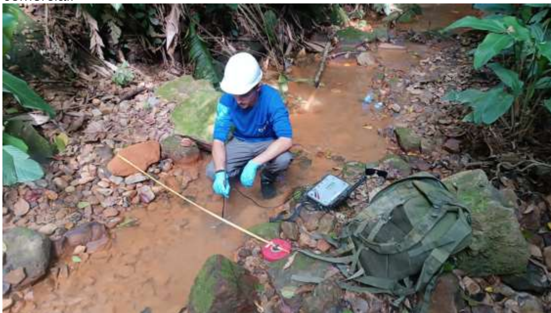
Figura 12: Realização da medição de vazão no ambiente de teste, com contador comercial.
