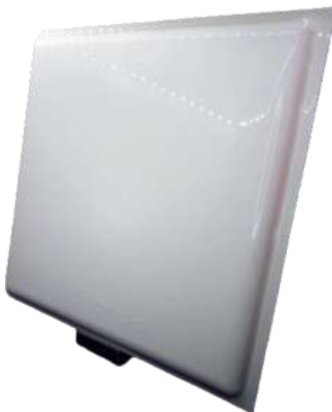
Figura 12: Antena para leitura das tags RFID.
