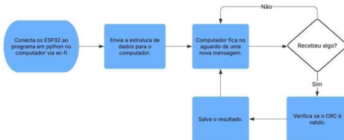
Figura 5: Fluxograma do processo de teste do ESP32 via Wi-Fi
