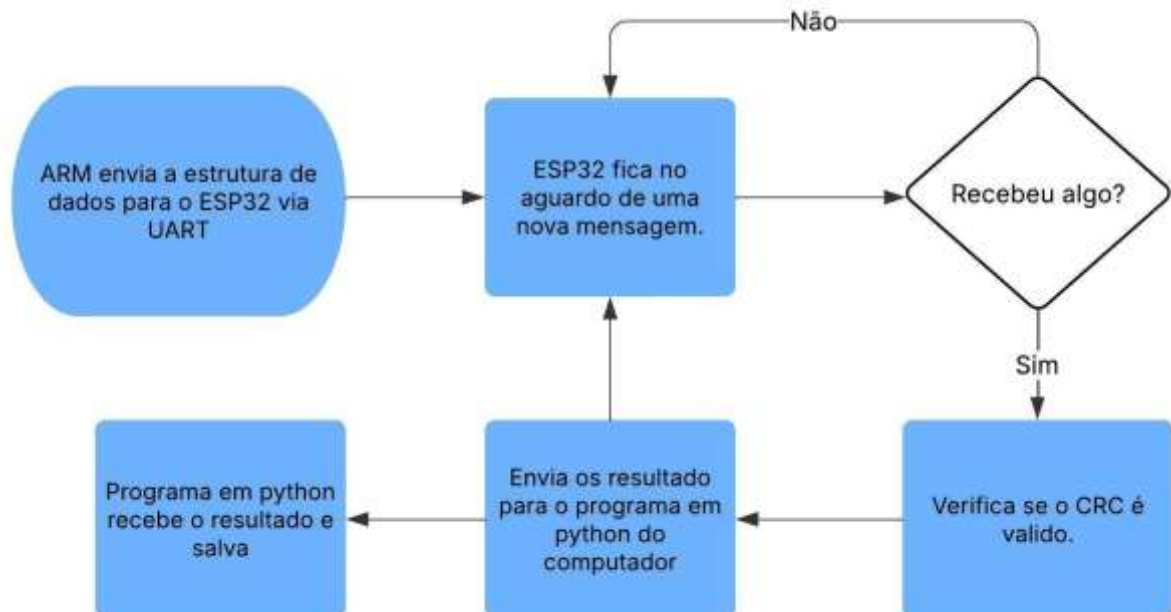
Figura 4: Fluxograma do processo de teste do STM32F412VGT6 via UART.
