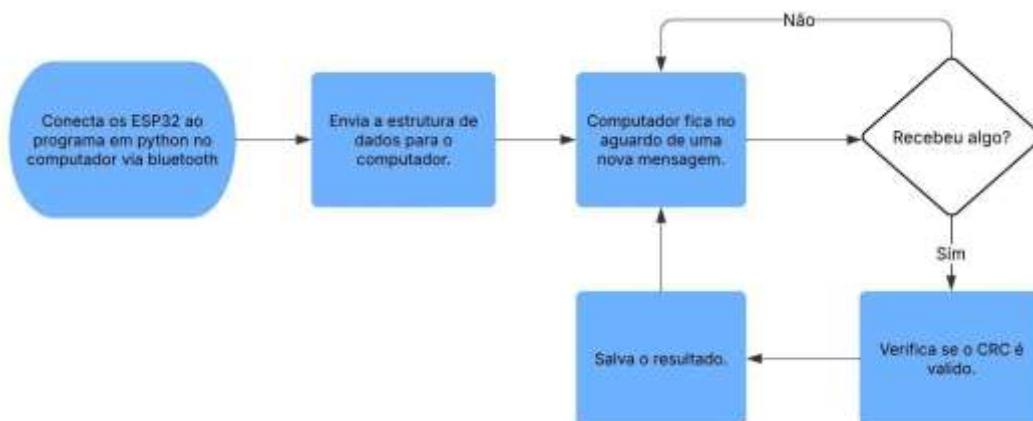
Figura 6: Fluxograma do processo de teste do ESP32 via Bluetooth.
