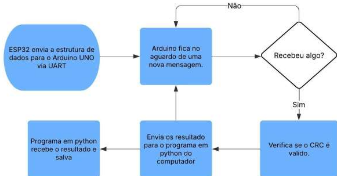
Figura 3: Fluxograma do processo de teste do ESP32 via UART.
