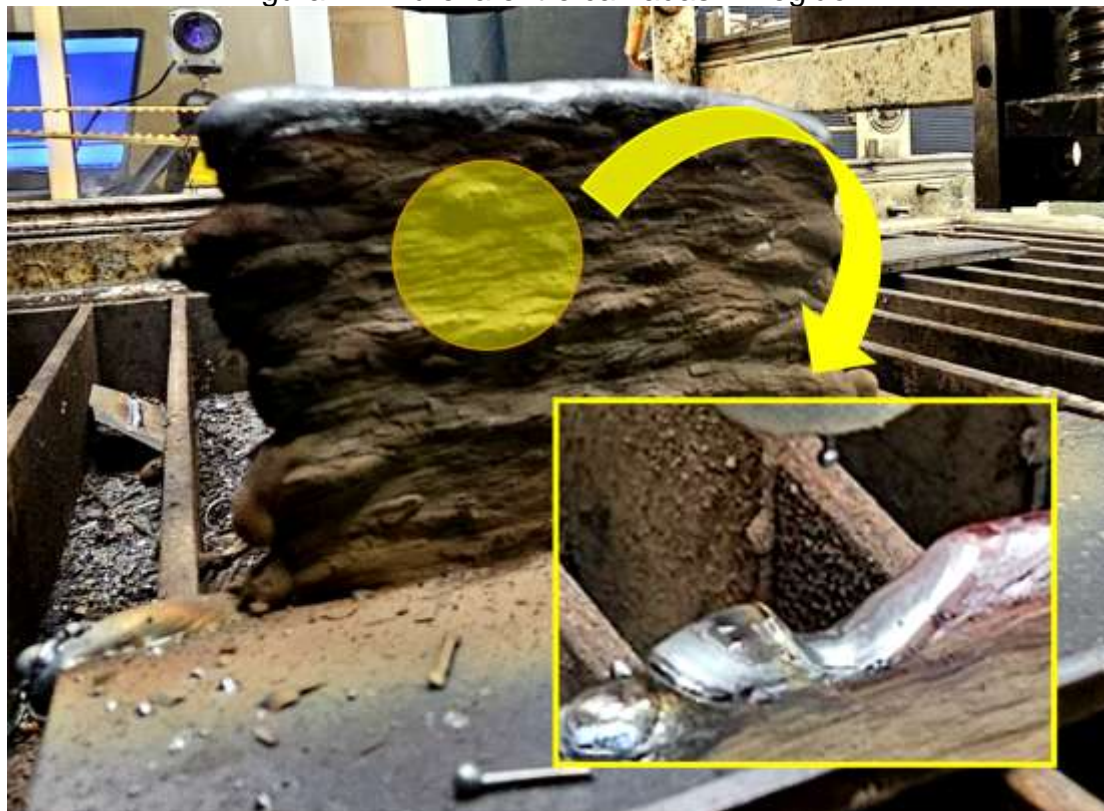
Figura 17: Dureza entre camadas – Região D.
