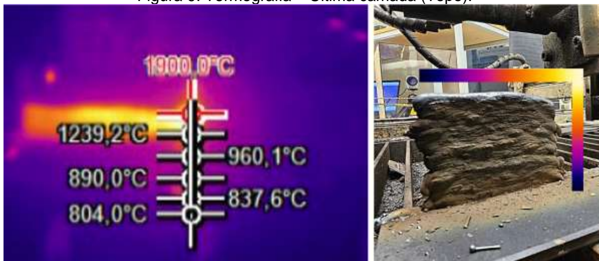
Figura 9: Termografia – Última camada (Topo).
