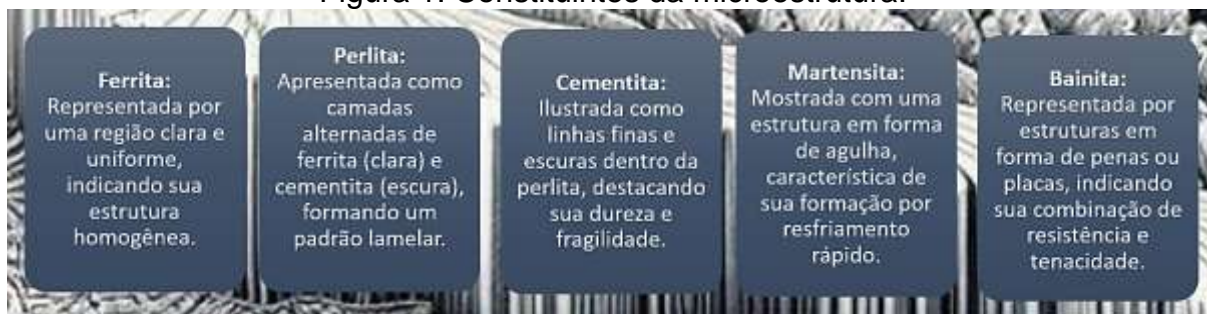
Figura 1: Constituintes da microestrutura.
