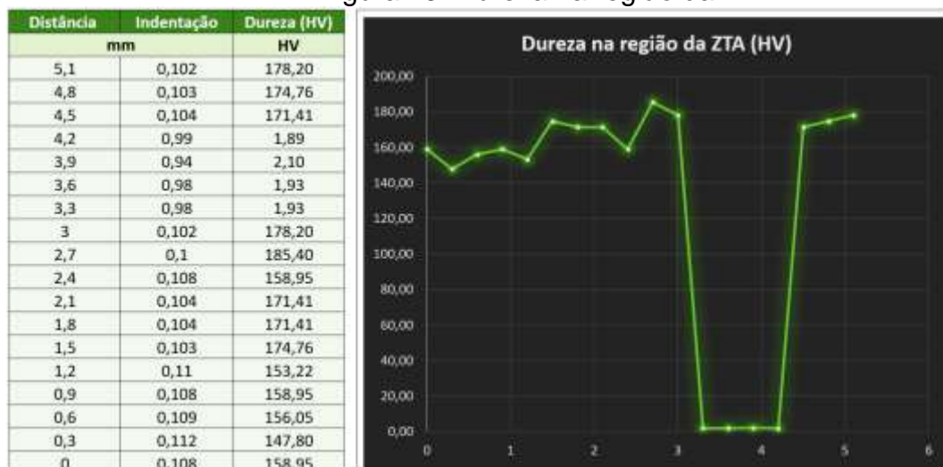
Figura 13: Dureza na região da ZTA
