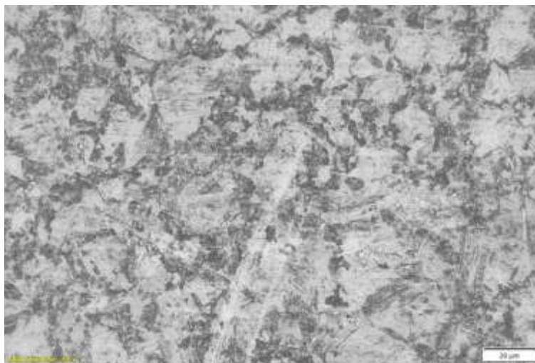
Figura 04 – Metalografia aço 1045 laminado a 0° revenido e temperado a água a 250°C.
