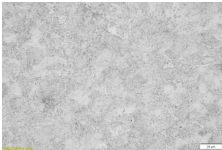
Figura 07 – Metalografia aço 1045 laminado a 0° revenido e temperado a óleo a 550°C.
