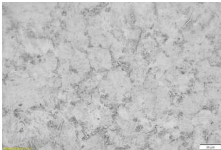
Figura 06 – Metalografia aço 1045 laminado a 0° revenido e temperado a óleo a 250°C.
