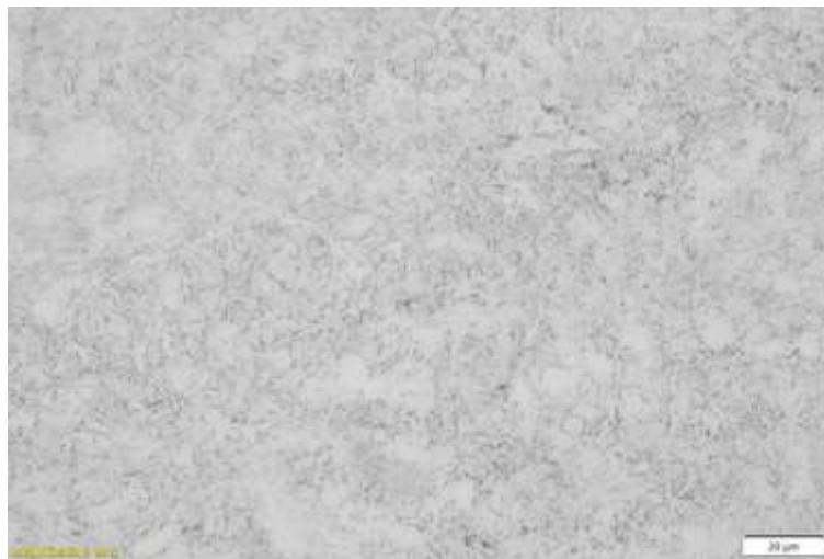
Figura 05 – Metalografia aço 1045 laminado a 0° revenido e temperado a água a 550°C.
