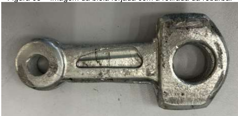
Figura 05 – Imagem da biela forjada com a retirada da rebarba.
