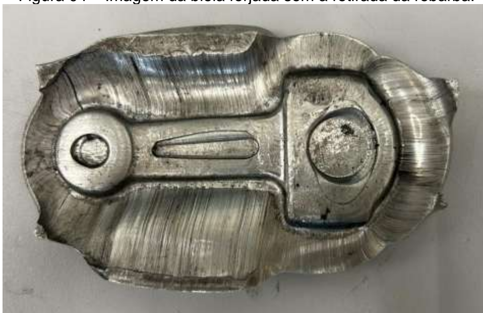
Figura 04 – Imagem da biela forjada sem a retirada da rebarba.
