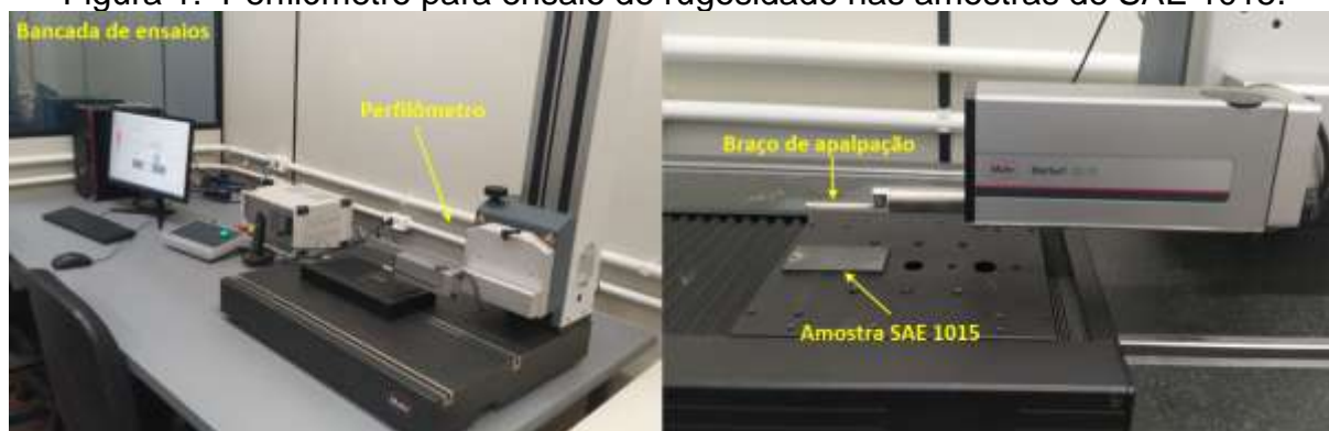
Figura 1: Perfilômetro para ensaio de rugosidade nas amostras de SAE 1015.
