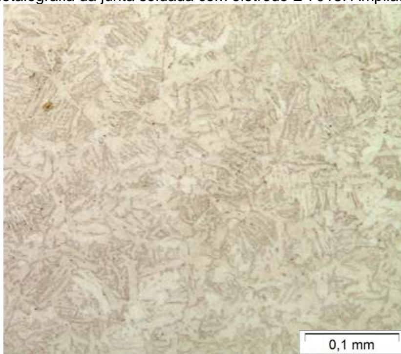
Figura 7: Metalografia da junta soldada com eletrodo E 7018. Ampliação de 200x.
