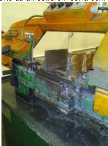
Figura 4: Corte da amostra em serra com refrigeração.
