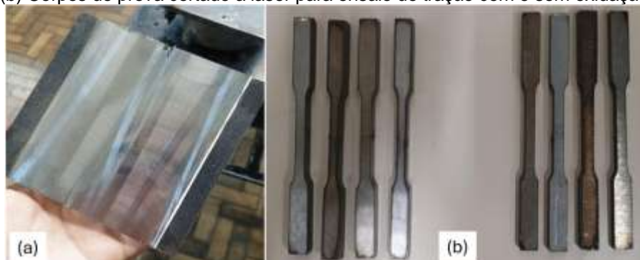
Figura 3: Preparação material para ensaio de tração: (a) Corpo de prova usinado; (b) Corpos de prova cortado a laser para ensaio de tração com e sem oxidação.
