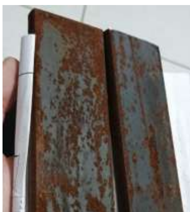
Figura 1: Corpo de prova antes da soldagem com oxidação
