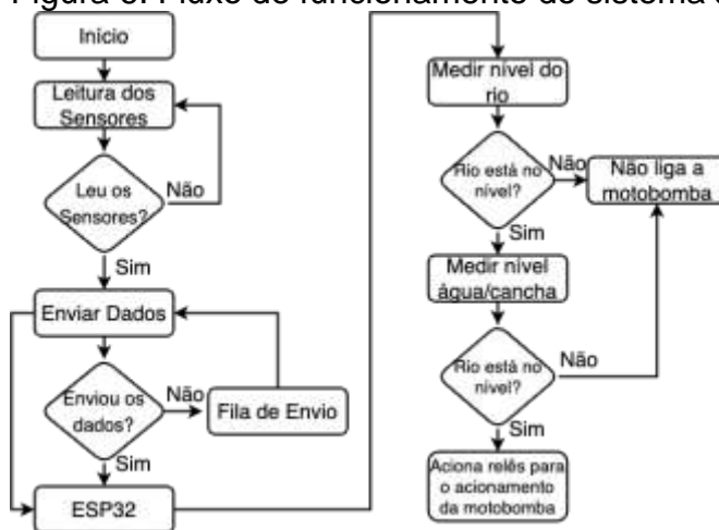
Figura 6: Fluxo de funcionamento do sistema automático.
