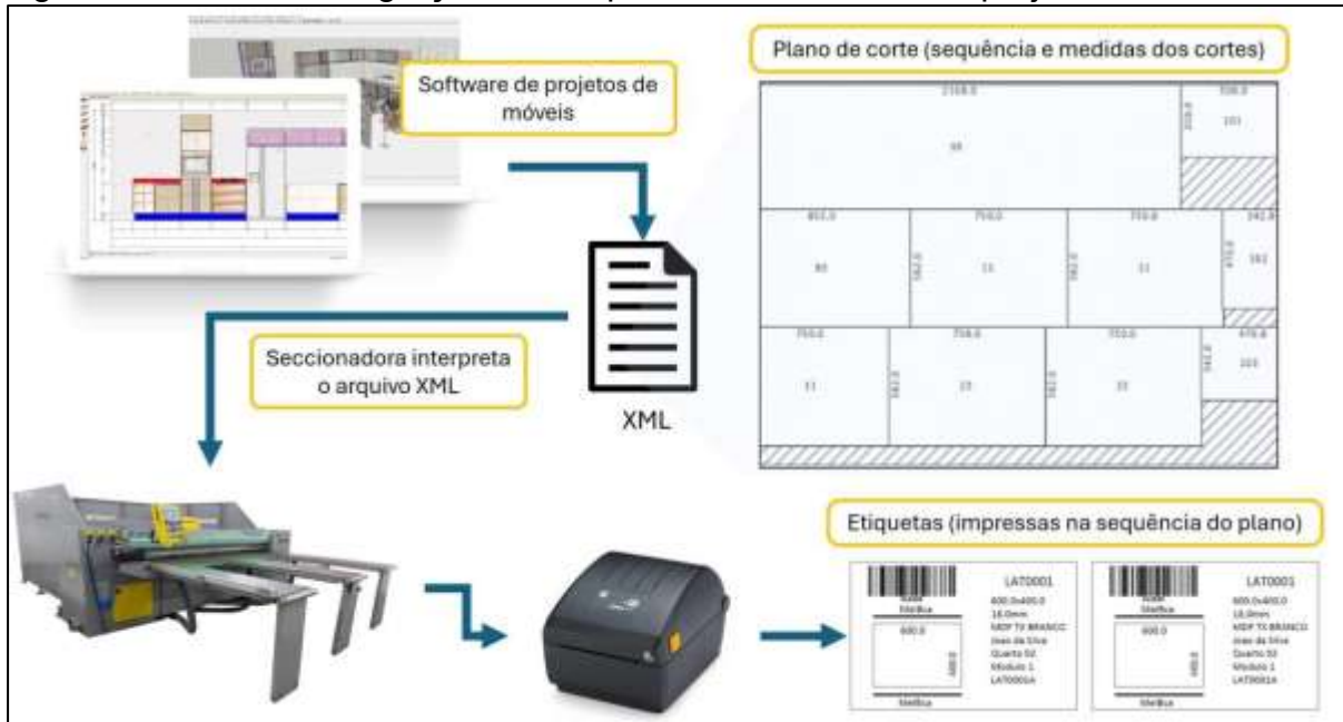
Figura 23: Fluxo de integração da máquina com softwares de projetos de móveis
