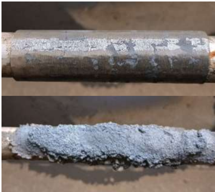
Figura 3 – Corpo de Prova antes e após aspersão térmica.
