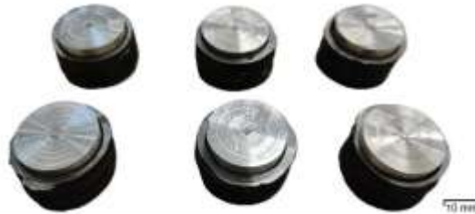
Figura 3: Montagem dos anéis e núcleos antes do forjamento
