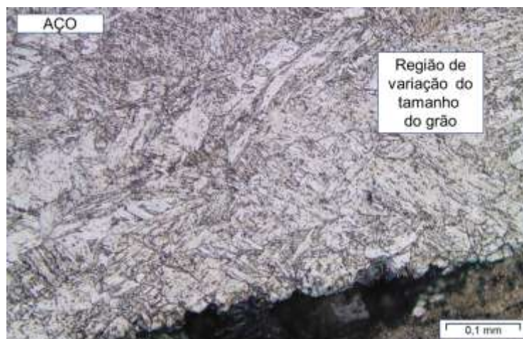
Figura 10: Alteração do tamanho dos grãos próximos à união
