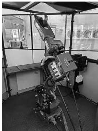
Figura 1: Braço robótico de soldagem automática
