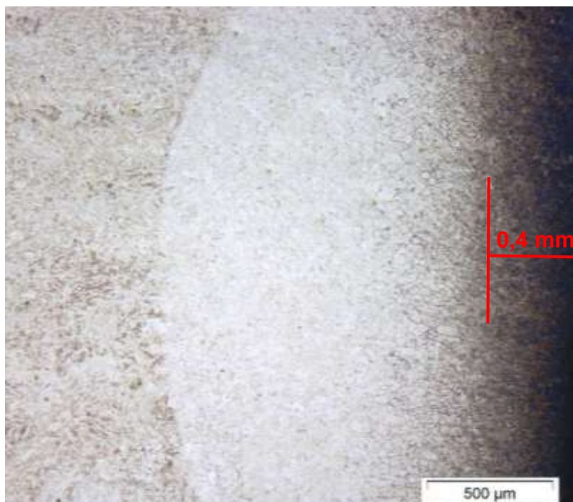
Figura 7 - Metalografia CP A36-SC. Superfície do corpo de prova.50x.
